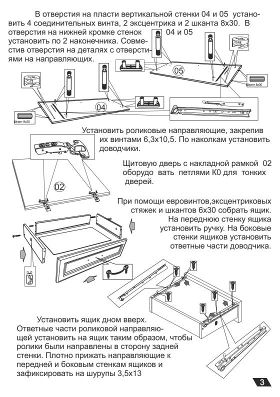
Собрать комод. Установить полку, ящик и дверь. На эксцентрики и евровинты установить заглушки. На дверь и переднюю стенку ящика установить ручки. Отрегулировать двери, при необходимости установить под ножки пластиковые подставки. Закрепить задние стенки к каркасу на соединитель задней стенки с шурупом.
